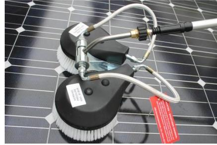
Für Selbstmontierer Hochdruckreiniger, 200bar, 1260ltr.
